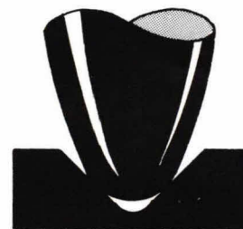
Afb. 4. Een goede naald in een schone groef: perfecte aftasting en geen ruis als er eens een klein vuiltje op de groefbodem ligt.
